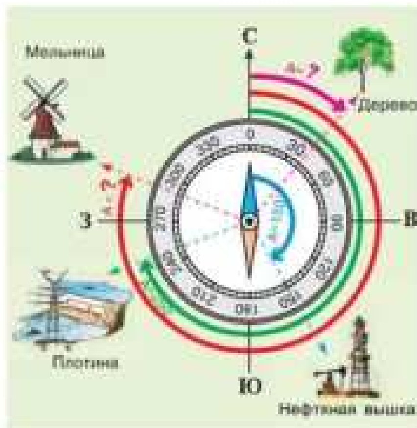
Рис. 20. Определение азимута на различные объекты
