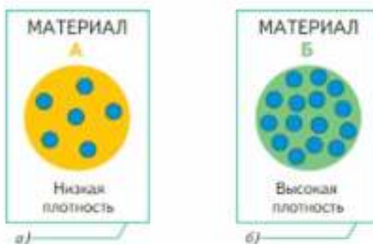
Рис. 6.1. Схема размещения молекул в материалах разной плотности
