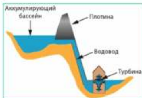
Рис. 10.6. Аккумуляция потенциальной энергии большими массами поднятой воды: а — накопительный бассейн; б — схема спуска воды к турбине
