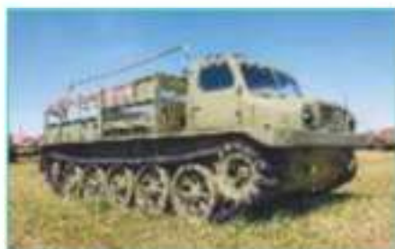
Рис. 2.5. Пример шестого уровня творчества — замена колёс в вездеходе на гусеницы
